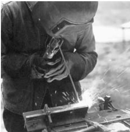
Etudiant de Cooper Union réalisant par soudure une pièce d'assemblage. In. Education of an Architect, 1964-71 (The Monacelli Press, 1999)
